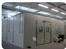
Тест на долговечность (40°C, 100% нагрузка, 180 дней)
